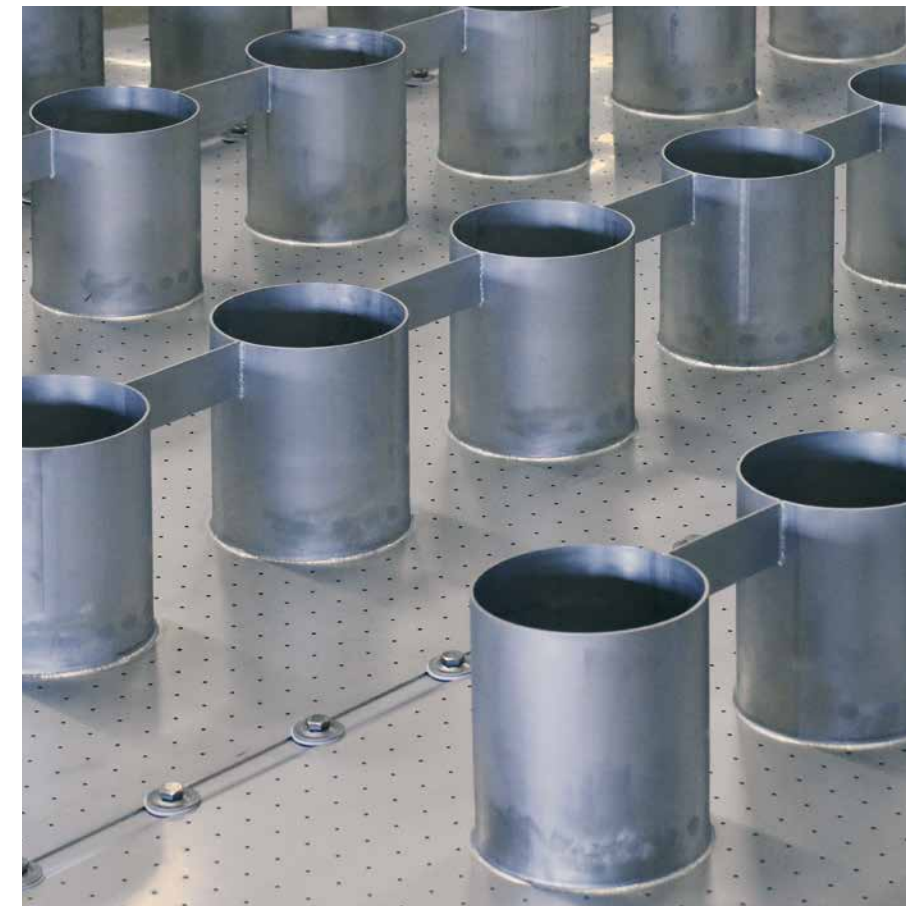
Verteilerboden mit Gaskaminen
