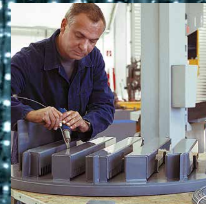
Fertigung eines Tunnelbodens aus Kunststoff
